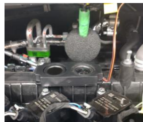
ユニット音響加振計装
