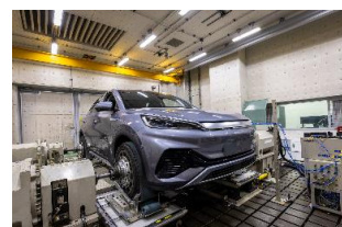
RC-S 実車トランジェントベンチ
